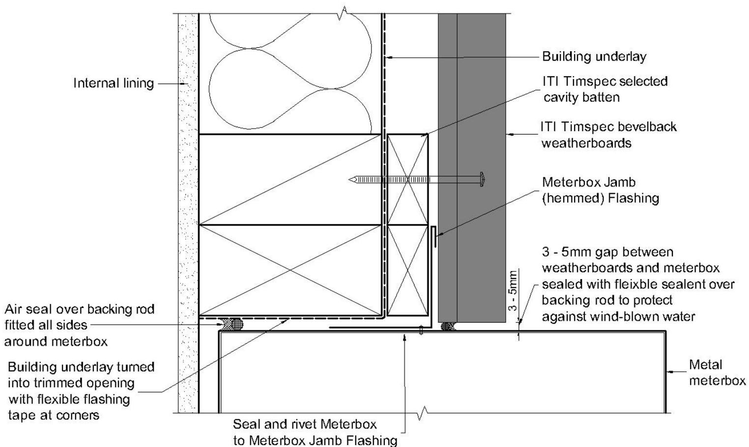
**FIGURE 13. 21 BC 803 METER BOX SILL**
