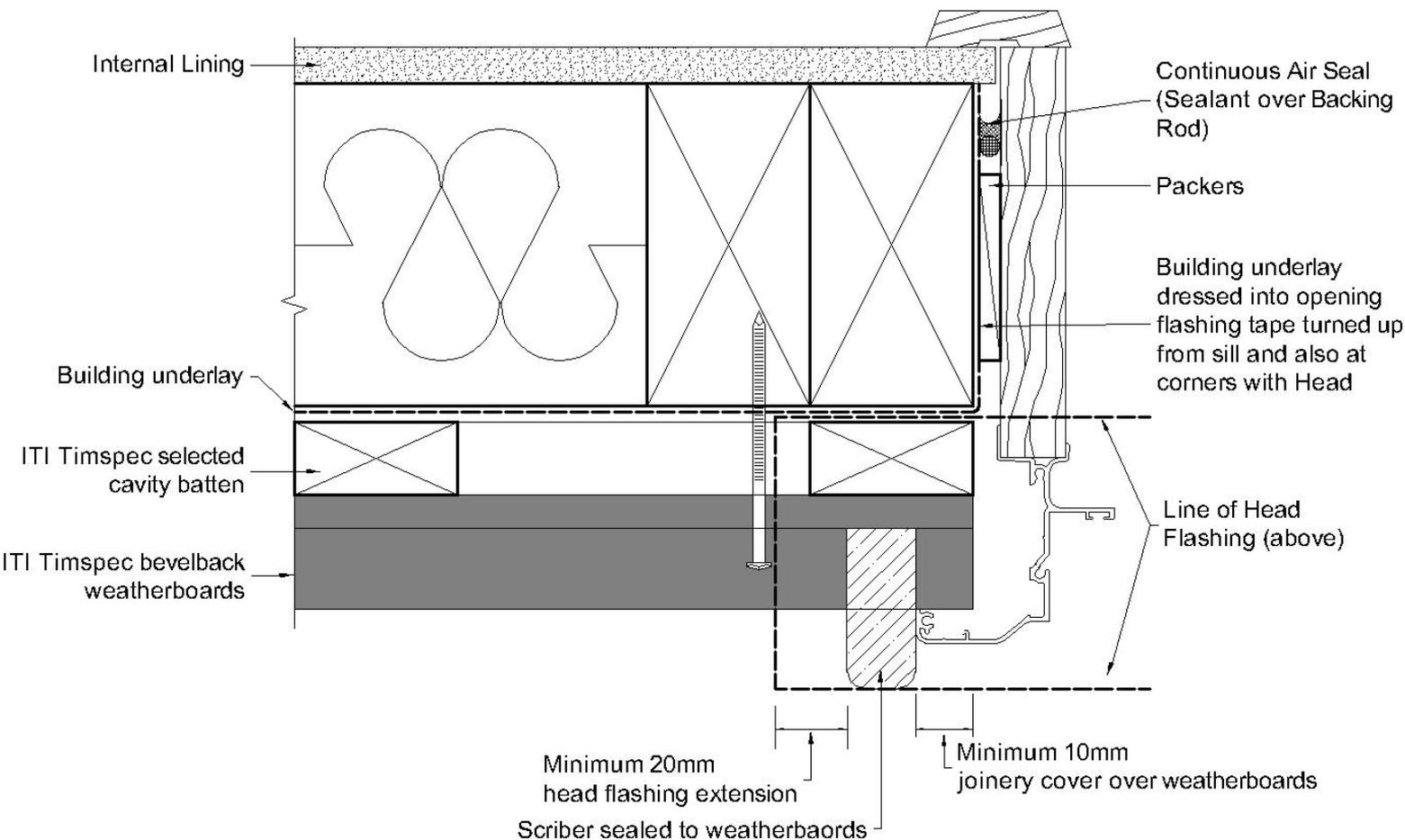
**FIGURE 13. 5 BC 203 WINDOW SILL – ALUMINIUM JOINERY**
