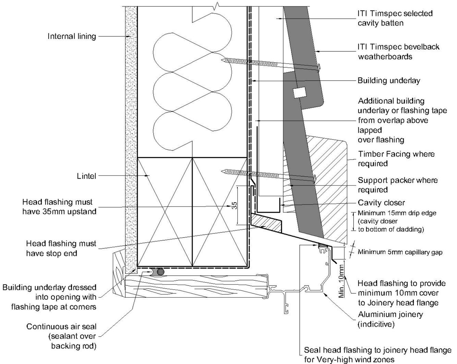
**FIGURE 13. 4 BC 202 WINDOW JAMB – ALUMINIUM JOINERY**
