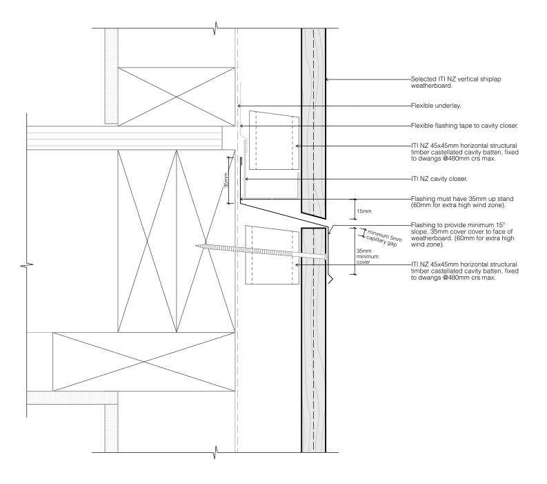
DETAIL 13.4 - 202 WITHIN BOARD JOINS - SCARF JOINT
